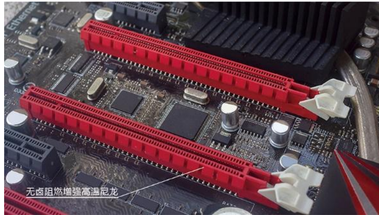
图 7 公司高温尼龙材料在电脑、服务器关键连接器上的应用场景图
